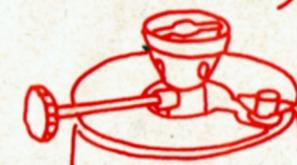
(4)予熱燃料が燃えつきる直前にハンドルを左へ廻し燃料皿に点火してください。点火当初はできるだけ小さな炎で2~3分間燃焼させバーナー部の確認をしましょう。予熱時間が不充分ですと完全燃焼の状態になるのに余分な時間を要します。
