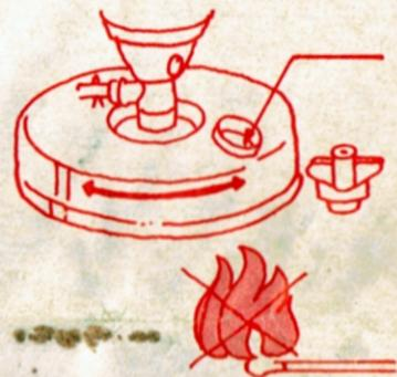
■燃料の充填(補給)が終ったらキャップを右廻しにしっかりと締めてください。ゆるんでいると燃料がもれ燃焼中に引火する恐れがあり危険です。
