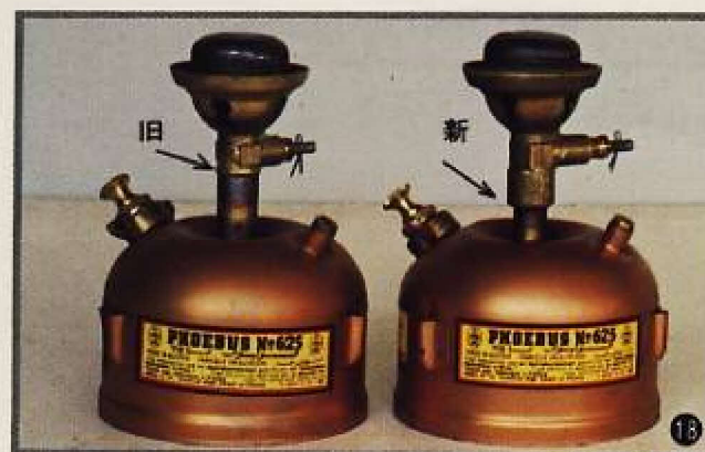
ヘッドとタンクの接続形状によって新旧ホエーブスの見分けができます。
