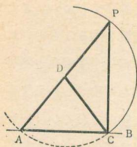
斜線APを想定し、その中点D点を決定する。D点からDPの長さを半径として綱で円弧を描いてAB線を切るところのC点を得ればPCを結ぶ直線がABに垂線になる。この説明は前節の二、半円周法と同じである。
