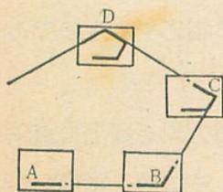
次に指方規をBに見通して図上に $a b$ 線を描く。 $a b$ の長さはA Bの何分の1かに定めておく。
