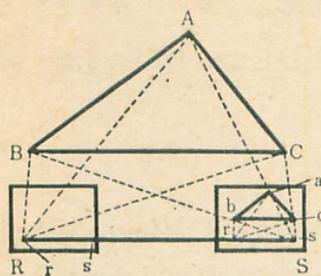
Cなる三角形の地面を測るのに、(第57図) その地域外の適宜の所に基線RSを定め、平板を据え、RSに相応する $rs$ の縮図を引き、 $rs$ はRSの方向に正しく一致せしめる。次に $a$ に指方規をあて、A、B、C、に向って $ar$ 、 $br$ 、 $cr$ 、を描く。
