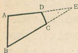
とがわかった時は、一辺のD Cを繫線と同様に見なして既述の方法でD C Eの三角形を図上に描き、D及びCの角の大きさを図上で決定し、A D及びB Cを縮尺で現わせばこの地形は容易く縮図出来るであろう。
