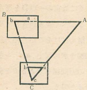
Bの方向に一致させ  $a$  より Aに向って指方規を用い  $a c$  線を引く、次に  $b$  より Bに向って指方規によって  $b c$  線を引くと、 $a c$  と  $b c$  が図上に交差した点  $c$  が C に相応する点となるのである。
