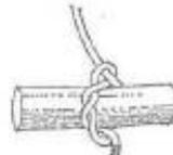
7. おし結び 丸柱、丸太などにロープの端を結びつけるのに使う。
