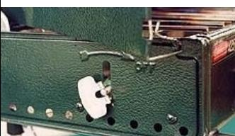
サブバーナーは単独では使用できません。メインバーナーを使用していることが前提で、点火はメインバーナーの炎が安定してから行なってください。ジェネレーターが十分加熱されないと、気化した燃料が届かないため炎は途切れますが、熱を帯びるとやがて安定します。
