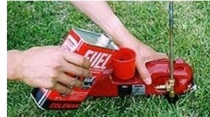
まず燃料バルブを締め、ポンプノブも止まるまで右に回しておきます。燃料は、ポンピングで圧力をかける空気をタンク内に残すため、満タンにせず 8 分目まで入れるのがポイントです。給油する時は付近に火気のない状態で、タンクを水平にして行ってください。
