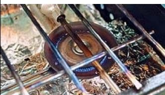
点火直後は赤い炎が出ることがありますが、ジェネレーターを通る燃料が気化されると青い色に変化し炎が安定します。安定しない場合は燃料バルブを素早く2~3回ひねってみてください。燃料の通りが良くなり安定します。安定したら点火レバーを下向きにし、燃料バルブで火力調整します。
