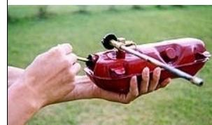
燃料バルブがOFFなどを確認したら、ポンプノブを左に2回転させ、親指でノブの穴を押さえながらポンピングを開始します。手前に引いて奥まで押し込む正確なストロークを繰り返し、固くなつてノブが入らなくなるまで続けます。目安は100~150回です。固くなつたら親指を外し、ノブを押し込んで止まるまで右に回します。
