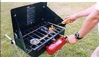
点火レバーを上にし、柄の長いライターなどの火をメインバーナーに近付け、燃料バルブを左に1~2回転させて点火します。点火直後、さらにポンピングします。目安は10~30回です。この時燃料タンクがずれないようしっかりと押さえてください
