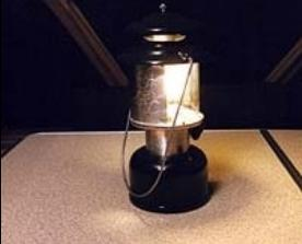
ランタンには光量を調節するバルブがついていますが、照らす方向を調節することはできません。そこでリフレクターと呼ばれるアクセサリーがメーカーから発売されています。これは、光を特定の方向だけに集めて照らす道具です。しかしアルミホイルがあれば、自作のリフレクターを作ることができます。グローブを外し、光を遮りたい部分にアルミホイルを貼るだけ。明かりを片方に集中できると同時に、反対側を間接照明のような柔らかい光に変えることができます。明眩、方向、隣接直接のそれぞれを使い分けて、夜の照明を演出してください。
