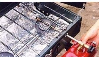
ジェネレーターの先端を本体の穴に通し、ミキシング部の穴に差し込みます。タンクのクリップを本体前部の穴に合わせて差し込み、しっかりと取り付けます。次にサブバーナーの燃料バルブが開いていないか確認し、開いていたら閉じてください。これで点火準備は完了です。
