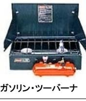
キャンプ場で最も多く見かけるストーブが、コールマン社製のこのタイプです。ホワイトガソリンを燃料とするツーバーナーは、実質的にコールマン社製しかありませんが、そのイメージ、実用性、耐久性などの点で大きな人気を誇っています。タンク内の空気を加圧して燃料を送り出す方式のため、ポンピングという作業が必要です。その分 LP ガス式のストーブより操作は面倒ですが、様々な条件下で得られる安定した火力は大きな魅力といえます。
